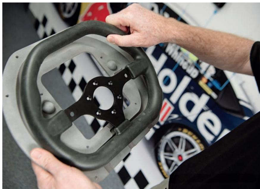
Ein aus Kunststoff gedrucktes Lenkrad
